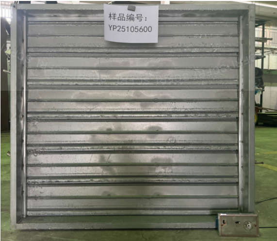
照片 2 试验结束后试件情况
